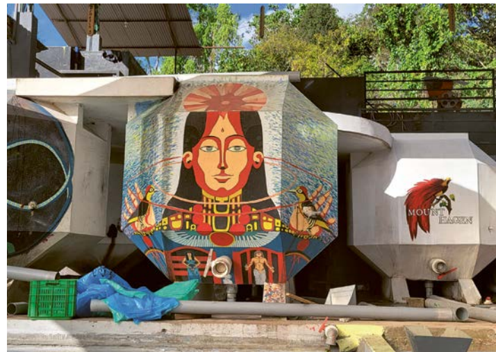
Auf der Farm La Chacra D'dago in Peru steuern spezielle Fermentationstanks den Prozess besser als die üblichen offenen rechteckigen Becken. Bemalt hat sie Eduardo Marin, einer der Inhaber-Söhne.
