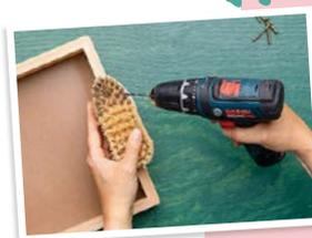
Bohre zwei Löcher für die Bürste vor (durch die Bürste bis in den Rahmen hinein), schraube die Bürste danach fest.
