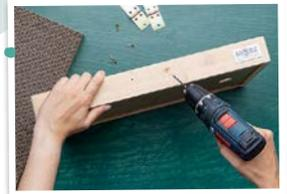
Halte die Scharniere mittig an der Seite des Rahmens an, markiere mit einem Bleistift die Bohrlöcher und bohre per Holzbohrer vorsichtig die Löcher für die Schrauben vor.
