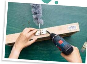
Klemme die Enden der Bürste an beiden Seiten des Rahmens jeweils unter die Scharniere und schraube diese sehr fest. Achte darauf, dass keine Schrauben oder Draht hervorstehen, damit deine Katze sich nicht verletzen kann.
