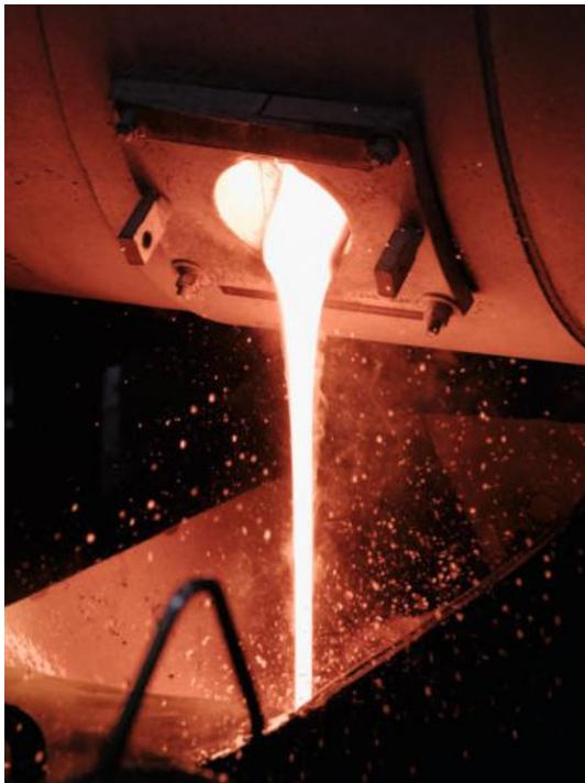
Bei 1500 Grad entsteht aus Zutaten wie Quarz, Borax und anderen flüssige Emaille, die dann in mehreren Schritten sprühfähig wird.
