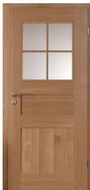
Massiv Füllungstür MG/3F-SP4, Eiche astarm lackiert, OG-Zarge 65 mm, Drücker R71 Nickel matt
