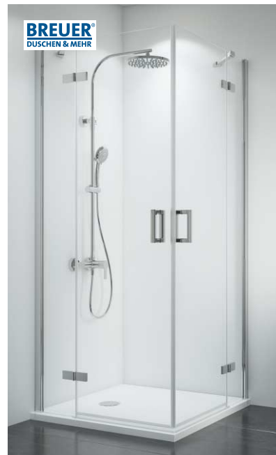
Panorama Drehdiaagonaleinstieg 6 mm ESG, flächenbündige Scharniere, inte- grierter Hebe-Senkmechanismus, Wandan- schlussprofile ohne sichtbare Verschraubungen, Breiten bis zu 1200 x 1200 mm möglich, beson- ders großräumiges Duschvergnügen
