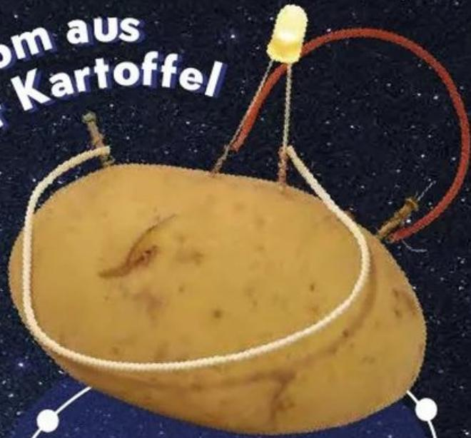
Steckt einen Kupfernagel und einen Zinknagel in eine Kartoffel, verbindet sie mit Drähten und einer kleinen LED, um zu sehen, wie die Kartoffel Strom erzeugt!
