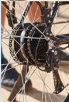
Kompakter Hinterradmotor, 36 V/250 W, mit direkter Kraftübertragung auf Ritzel und Kette
