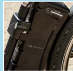
Kraftvoller Sideclick-Akku mit LG Zellen
