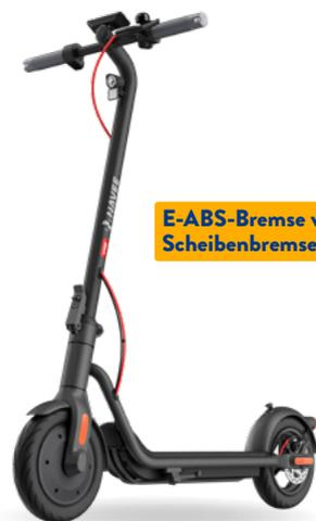
**E-ABS-Bremse vorne & Scheibenbremse hinten**
