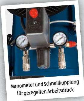
Manometer und Schnellkupplung für geregelten Arbeitsdruck
