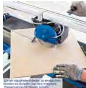
Für ein staubarmes Arbeiten ist es möglich, während die Schneide läuft eine ergonomische Wasserpumpe mit Wasser anzuschließen.
