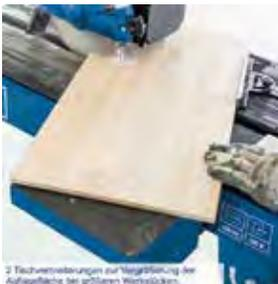
2 Teufelverstellungen zur Vergrößerung der Auflagefläche bei großem Materialstück.
