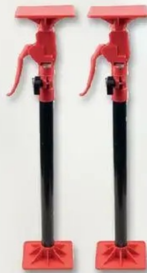
Baustützen 2er Set, teleskopierbar von 115-310 cm, Ø 32mm, Tragkraft 50 kg, Art.Nr.: 25992573
