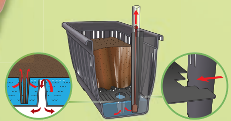
Mit Einfüllvorrichtung und Wasserstandsanzeige
