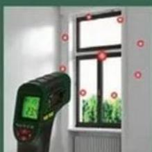
8-Punkt-Laser + Ausgangspunkt zur genauen Anzeige der Messfläche
