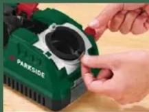
Einstellbarer Bohrspitzenwinkel: 115–140°
