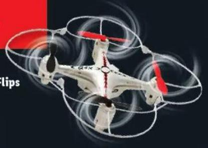
Quadrocopter „Q4X“; 4+5-Kanal-Fernsteuerung (2.4 GHz); selbststabilisierende 6-Achsen-Gyro-Fluglagenkontrolle mit Wurf-Start-Funktion für den Indoorflug; stabiles, leichtes ABS-Vollgehäuse
