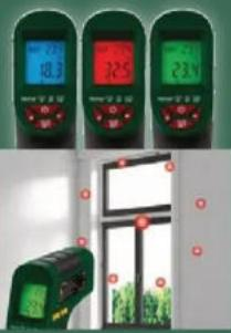
8-Punkt-Laser + Ausgangspunkt zur genauen Anzeige der Messfläche
