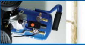
2 Schnellanschlusskupplungen für einen schnellen Werkzeugwechsel
