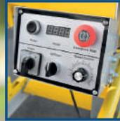
**Elektrische Höhenverstellung mit variabler Geschwindigkeit**
