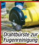
Drahtbrste zur Fugenreinigung
