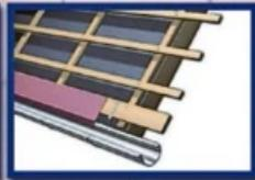
Übergangsblech von der Traufe zur Dachrinne. Leitet Wasser auf Dachflächen ab und schützt somit die Dacheindeckung.
