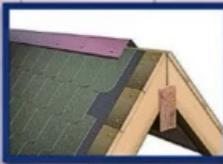
Dient zum fachgerechten Firstabschluss und schützt die Dacheindeckung vor eindringendem Wasser.
