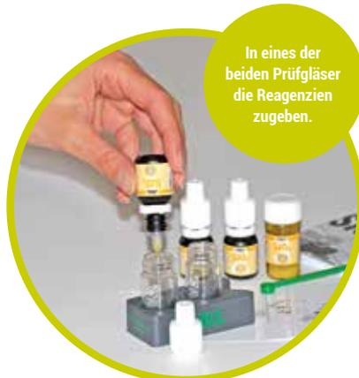
In eines der beiden Prüfgläser die Reagenzien zugeben.
