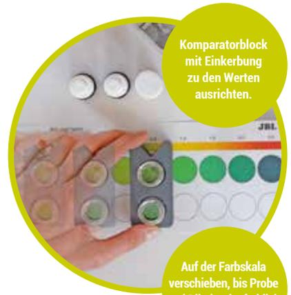
Komparatorblock mit Einkerbung zu den Werten ausrichten.
