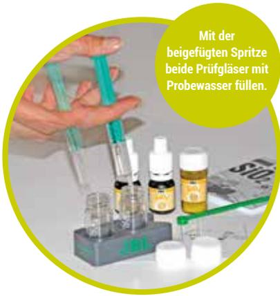
Mit der beigefügten Spritze beide Prüfgläser mit Probewasser füllen.
